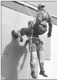
Beispiel: Evakuierung mit dem Milan Abseilgerät.
